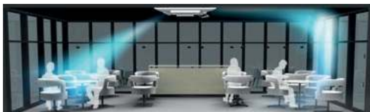
Направление воздушного потока панели по предотвращению сквозняков
