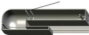
Место установки фильтра очистки
