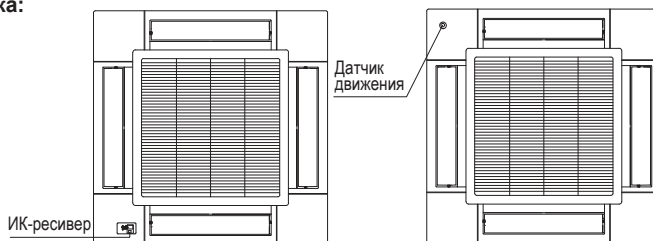
Направление воздушного потока без спецзаслонки.
