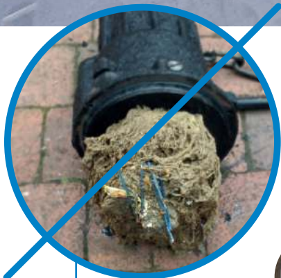
Заблокированный насос без системы измельчения
