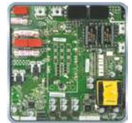
Высокоскоростной вычислительный модуль векторного управления
