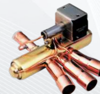
4-х ходовой клапан. Переключает режимы охлаждения / обогрева
