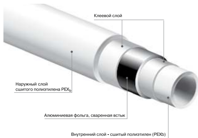
Рисунок 1. Структура трубы PE-Xb/Al/PE-Xb
